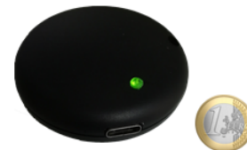
Fig. 1. Capteur sans fil MMG MOTEN pouvant mesurer pendant 20 heures l'activité musculaire.
